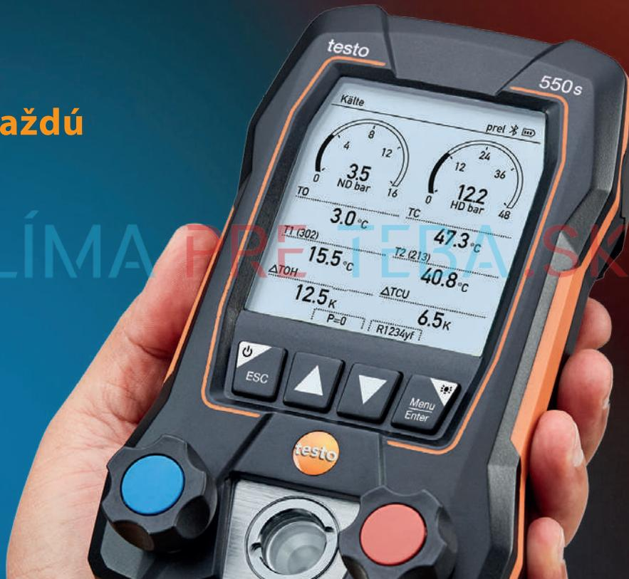
Vďaka digitálnym analyzátorom chladenia testo 550s a testo 557s sú merania na chladiacich a klimatizačných systémoch a tepelných čerpadlach rýchlejšie a jednoduchšie ako kedykoľvek predtým. Veľký displej zobrazuje všetky namerané údaje na prvý pohľad a zjednoduší analýzu výsledkov. Ponuky merania vás krok za krokom prevedú meraním a umožnia automatické určenie dôležitých parametrov zariadenia, ako je prehriatie, test poklesu tlaku,
